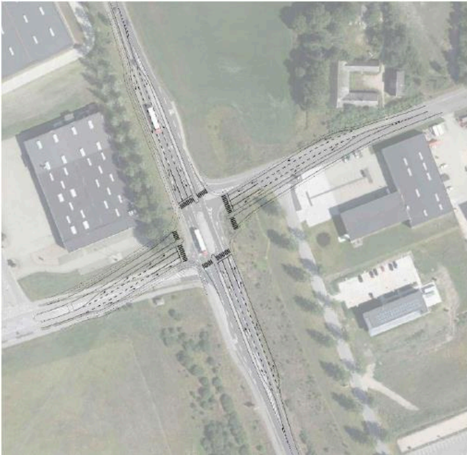
Figur 5: Skitse af ombygning af krydset Jyllandsgade/Uhregårds Allé/Europavej til signalreguleret firbenet kryds
