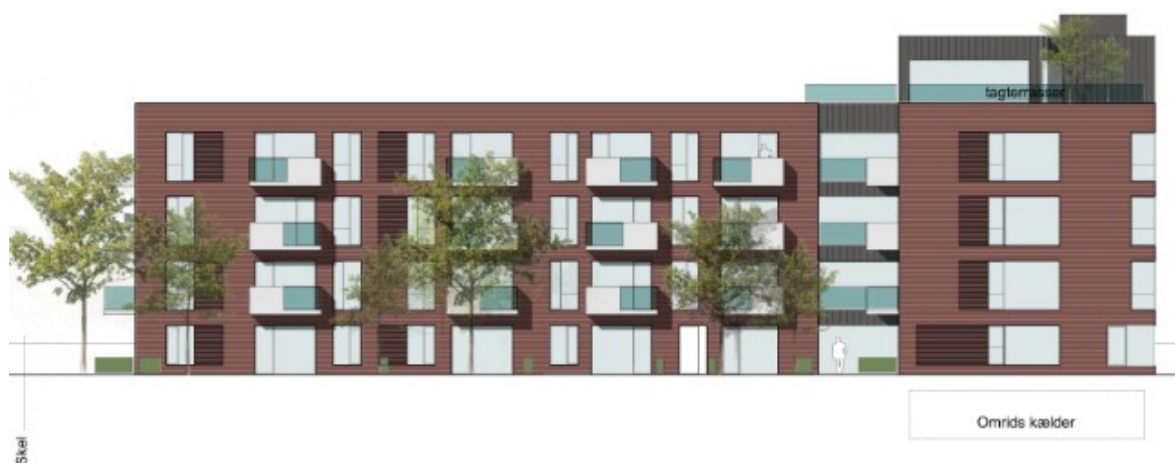
Facade set fra Kirkegade. Til højre ses vinklen mod Kirkegade - den 5. etage er trukket adskillige meter væk fra Kirkegade.
